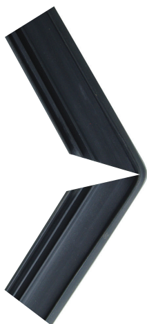
Ausklinken einer Flügelecke - V-Schnitt
