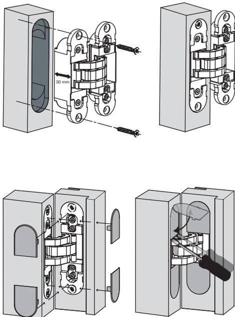
Das Bandteil mit der Aufschrift "door" (Tiefe 30 mm) in das Türblatt einsetzen, wobei die korrekte Öffnungsrichtung beachtet werden muss. Es folgt die Befestigung der Bänder durch das Einschrauben von geeigneten Schrauben (mind. Ø5x20mm).
