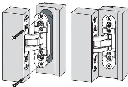
Das Türblatt in den Rahmen einsetzen, indem das Band-Rahmenteil (Tiefe 21 mm) in die Rahmenfräsung eingesetzt wird. Danach folgt die Befestigung der Bänder durch das Einschrauben von geeigneten Schrauben (mind.  $\text{\O}5 \times 20 \text{ mm}$ ).
