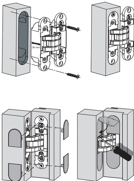
Das Bandteil mit der Aufschrift "door" (Tiefe 30 mm) in das Türblatt einsetzen, wobei die korrekte Öffnungsrichtung beachtet werden muss. Es folgt die Befestigung der Bänder durch das Einschrauben von geeigneten Schrauben (mind.  $\text{\O}5 \times 20 \text{ mm}$ ).
