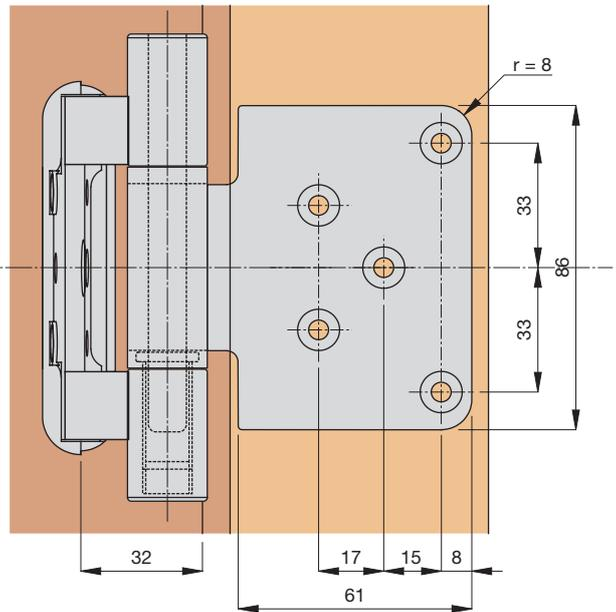
Bei Verwendung von Aluminiumschalenhaltern mit 4 mm Höhe kann der Flügellappen einfach aufgeschraubt werden. Bei Verwendung von Aluminiumschalenhaltern mit geringer Höhe können spezielle Flügellappen gefertigt werden.
